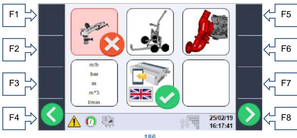
Cette page permet de compléter la configuration de la machine en fonction de la construction mécanique et des dispositifs réellement installés.
