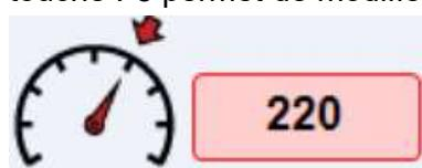
**Potentialité** : valeur pour la gestion du réglage de vitesse, comme point de départ il est possible d'utiliser la vitesse maximum de la machine. Si le réglage est très lent, il faut diminuer la valeur, si au contraire le système corrige trop brusquement sans stabiliser la vitesse (oscillation), il faut augmenter la valeur.
