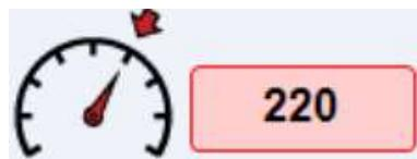
**Potential:** Wert für die Drehzahlregelung, die maximale Drehzahl der Maschine kann als Ausgangspunkt verwendet werden. Bei sehr langsamer Einstellung muss der Wert herabgesetzt werden; erfolgt hingegen die Korrektur zu rasch, ohne Stabilisierung der Geschwindigkeit (Pendeln),
