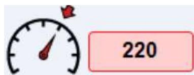
**Potencialidad:** valor para gestionar la regulación de la velocidad, como punto de inicio se puede usar la velocidad máxima de la máquina. En caso de que la regulación sea muy lenta, debe reducirse el valor; si al contrario, el sistema correge de forma demasiado brusca, sin estabilizar la velocidad (oscilación) debe incrementar el valor.
