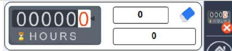
der erste Wert (mit dem Gummi auf der Seite) entspricht dem Teilstundenzähler, der zurückgesetzt werden kann indem die F7-Taste mindestens 5 Sekunden lang gedrückt wird; ebenfalls ist die erste Passwortebene erforderlich. Der zweite Wert entspricht der Gesamtbetriebszeit der Maschine, die nur im Falle einer Änderung der Seriennummer zurückgesetzt wird.
