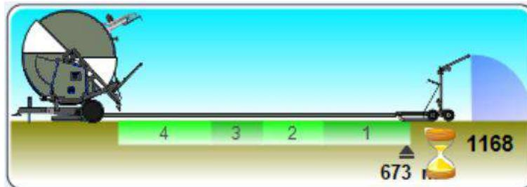
Le sablier attire l'attention sur le compte à rebours du temps initial qui démarre au START et maintient la machine à la vitesse zéro en irriguant une zone pour le temps configuré.
