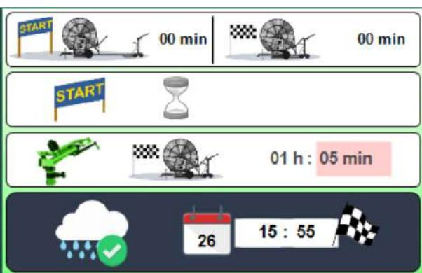
Tramite la prima impostazione è possibile definire se il secondo irrigatore deve funzionare per il tempo impostato (figura 70) nella fase di partenza (carrello completamente fuori figura 68) o nella fase vicino alla fine lavoro (carrello vicino alla macchina figura 69)
