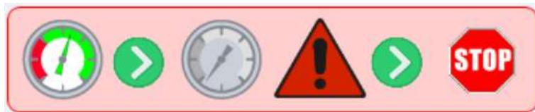
Avec cette sélection, si la pression descend en dessous du seuil minimum la machine s'arrête, la vanne est fermée et l'alarme de pression est donnée. La machine se met en état de STOP et ne peut repartir qu'après l'intervention d'un opérateur.
