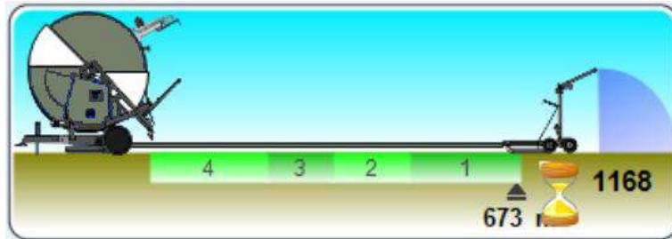
Die Sanduhr weist auf den Countdown der ersten Zeit hin, die bei START beginnt und die Maschine auf Nullgeschwindigkeit hält, indem sie einen Bereich für die eingestellte Zeit berechnet.
