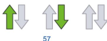
Le frecce (figura 57) rappresentano rispettivamente l'invio da parte della macchina di informazioni ai numeri abilitati, la ricezione di messaggio da parte di altri numeri (che il sistema elaborerà) oppure nessun messaggio in fase di invio/ricezione.
