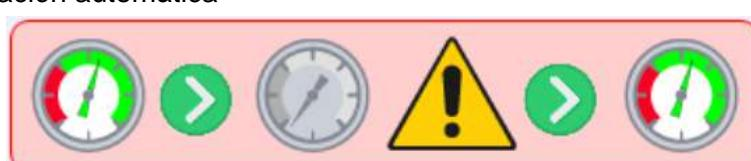
Con esta selección, en caso de que la presión descienda por debajo del umbral mínimo, la máquina se para, cierra la válvula de entrada y espera a que aumente la presión por encima del umbral mínimo, para volver a abrir la válvula y para volver a empezar el ciclo (la máquina permanece en el estado de START). No existen límites para la cantidad de pausas.
