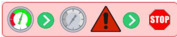
Con questa selezione nel caso la pressione scenda al di sotto della soglia minima la macchina si arresta, la valvola viene chiusa e viene dato l'allarme di pressione. La macchina va in stato di STOP e può ripartire solo dopo l'intervento di un operatore.
