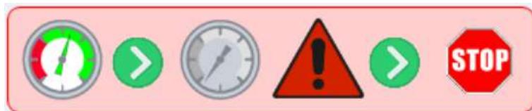
Bei dieser Auswahl stoppt die Maschine sobald der Druck unter den Mindestwert absinkt, das Ventil wird geschlossen und der Druckalarm ausgelöst. Die Maschine stoppt und kann erst nach Eingriff vonseiten einer Arbeitskraft wieder gestartet werden.
