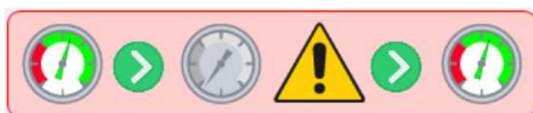
Bei dieser Auswahl stoppt die Maschine, schließt das Einlassventil und wartet, bis der Druck über den Mindestschwellenwert steigt, um das Ventil wieder zu öffnen und den Zyklus erneut zu starten (die Maschine bleibt im Zustand START). Die Maschine kann beliebig oft gestoppt werden.
