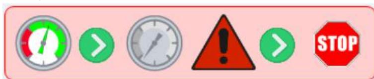
Con esta selección, en caso de que la presión descienda por debajo del umbral mínimo, la máquina se para, la válvula se cierra y aparece la alarma de presión. La máquina se coloca en estado de STOP y solo puede retomar el funcionamiento tras la intervención del operador.
