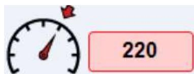
**Potenzialità:** valore per la gestione della regolazione di velocità, come punto di partenza si può usare la velocità massima della macchina. Nel caso la regolazione fosse molto lenta si deve abbassare il valore, se al contrario il sistema correge troppo bruscamente senza stabilizzare la velocità
