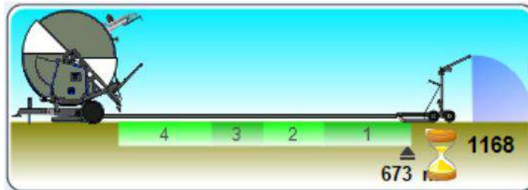
El reloj de arena llama la atención sobre la cuenta atrás del tiempo inicial que empieza con el START y mantiene la máquina a velocidad cero, regando una zona durante el tiempo programado.
